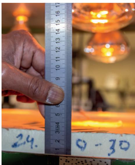
*Cet essai simule la déformation par cintrage d'un panneau isolant sous l'effet d'un gradient thermique. Des capteurs de température permettent de contrôler la température appliquée pendant la durée de l'essai. La déformation est mesurée à l'aide d'un réglét.*
