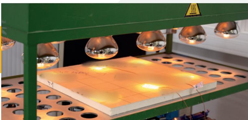
*Essai de variation dimensionnelle résiduelle : l'éprouvette est soumise à plusieurs cycles de conditionnement en température puis refroidissement à température ambiante afin de mesurer la variation dimensionnelle résiduelle après stabilisation. Les dimensions longueur, largeur et à mi-épaisseur sont mesurées après chaque cycles jusqu'à stabilisation. La variation peut être un retrait ou une dilatation de l'éprouvette.*
